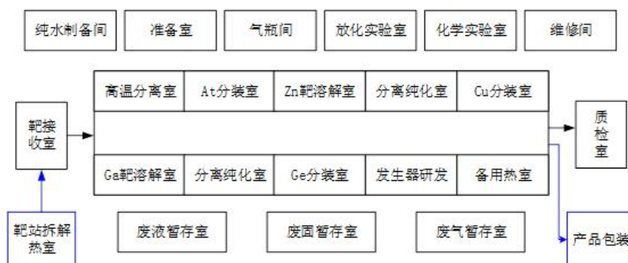
图 3-20 分离热室设计示意图
